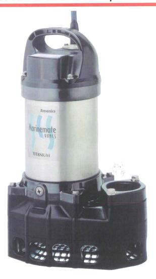
Turbine, arbre, chemise de moteur et visserie sont en titanium. Les autres pièces sont chacune en une résine industrielle sélectionnée après de longs essais en laboratoire et à l'oeuvre. La turbine, du type semi-vortex, est peu sensible à l'usure par du sable éventuel. Dans un bain de paraffine liquide, deux garnitures assurent l'étanchéité.
